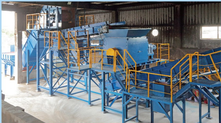
处理规模: 200t/d 处理工艺: 链板输送+破袋+人工分拣平台+磁选+滚筒筛分+压榨脱水 项目名称: 上海闵行-生活垃圾减容减量
