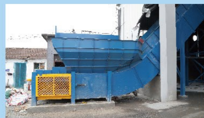
处理规模: 200t/d 处理工艺: 链板输送+破袋+人工分拣平台+磁选+滚筒筛分+压榨脱水 项目名称: 上海闵行-生活垃圾减容减量
