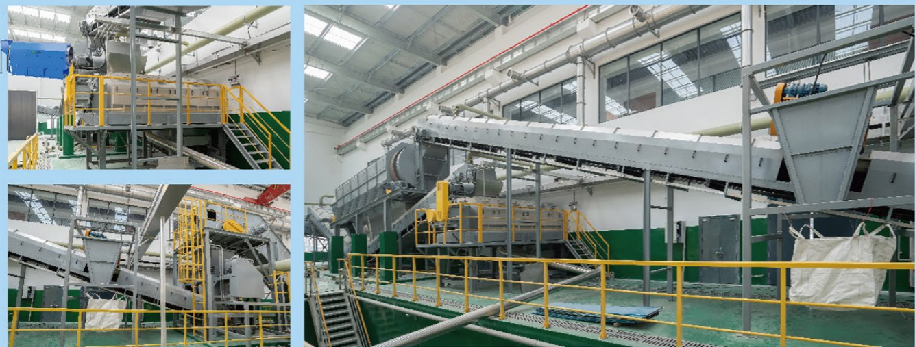
处理规模: 100t/d 处理工艺: 链板输送+破碎+皮带输送+磁选+滚筒筛分+压榨脱水 项目名称: 浙江嘉善-厨余垃圾厌氧协同焚烧
