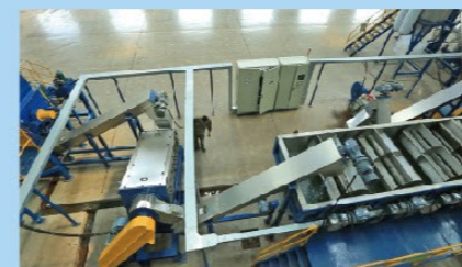
处理规模: 1吨/小时 处理工艺: 破碎+清洗+风送+干燥+色选 项目名称: 湖南-蓄电池塑料壳回收利
